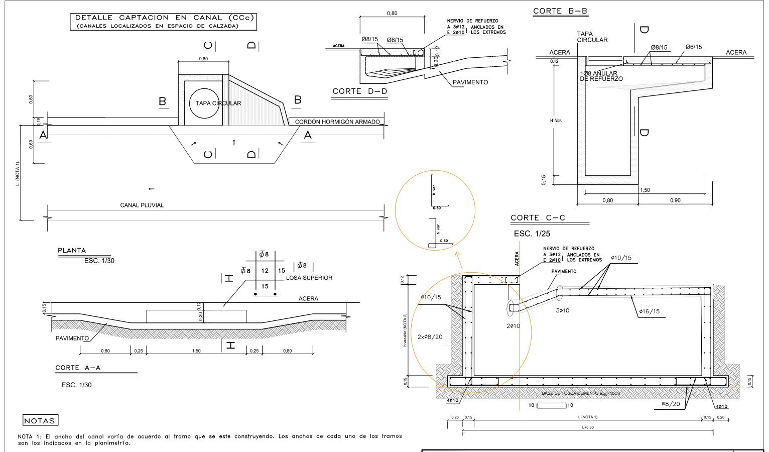
NOTA 2: La altura del canal es variable conforme se muestra en el perfil altimétrico.
